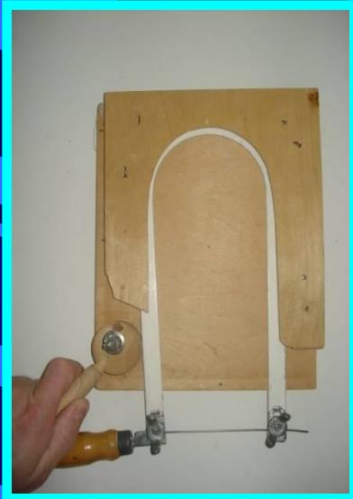
Для стягивания рамки перед креплением пилки применяют эксцентриковый зажим (см. рис.). После закрепления пилки винтами эксцентриковый зажим снимают. Пилка под действием рамки натягивается.
