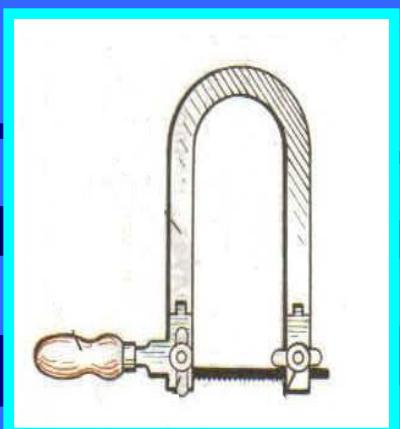
Сжимать рамку можно и вручную. Для этого один конец рамки упирают, например, в крышку стола, левой рукой нажимают на другой конец рамки, а правой закрепляют пилку зажимными винтами.
