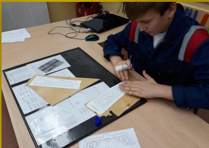
1. Наклеивание на заготовку бумаги с рисунками деталей
