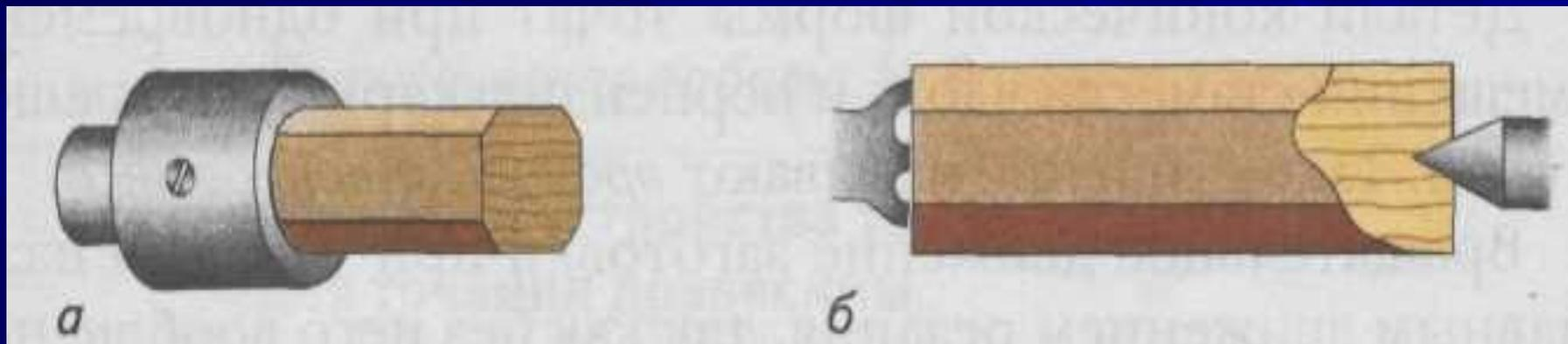
**а – в патроне винтом, б – трезубцем с поджатием центром задней бабки**
