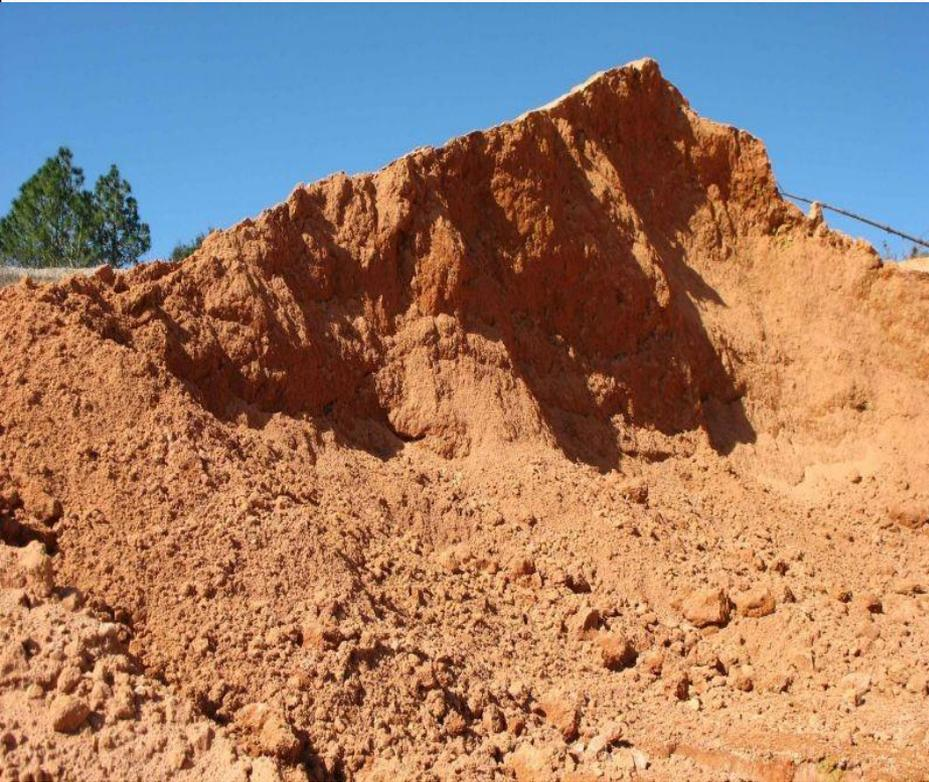
По своему составу глины делятся на **жирные** (с большим содержанием глинистых минералов), **нормальные и тощие** (с малым содержанием глинистых минералов, но большим содержанием песчаных частиц).
