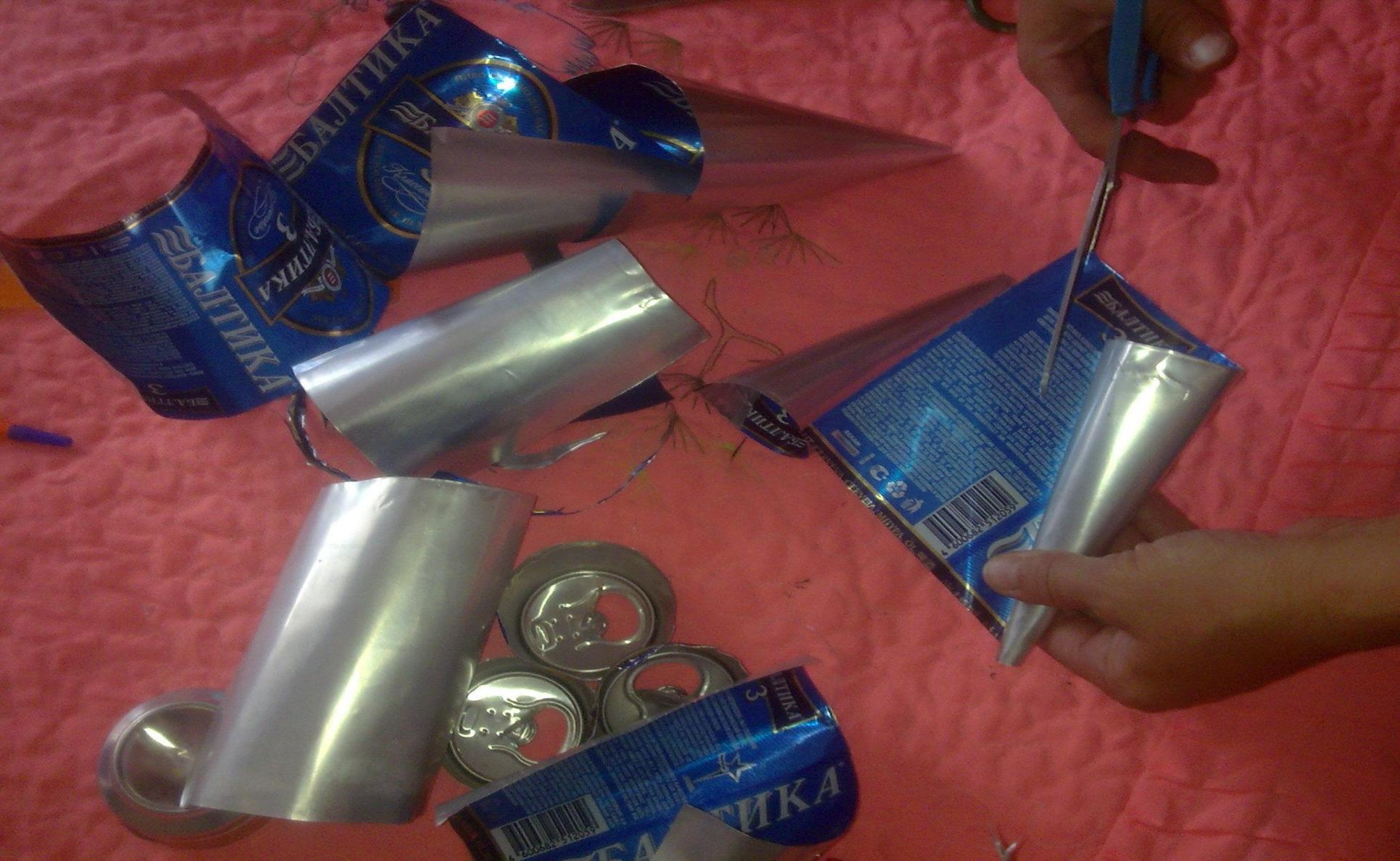
**Осторожно выполняем разрез по намеченной линии от угла на середину металлического прямоугольника**
