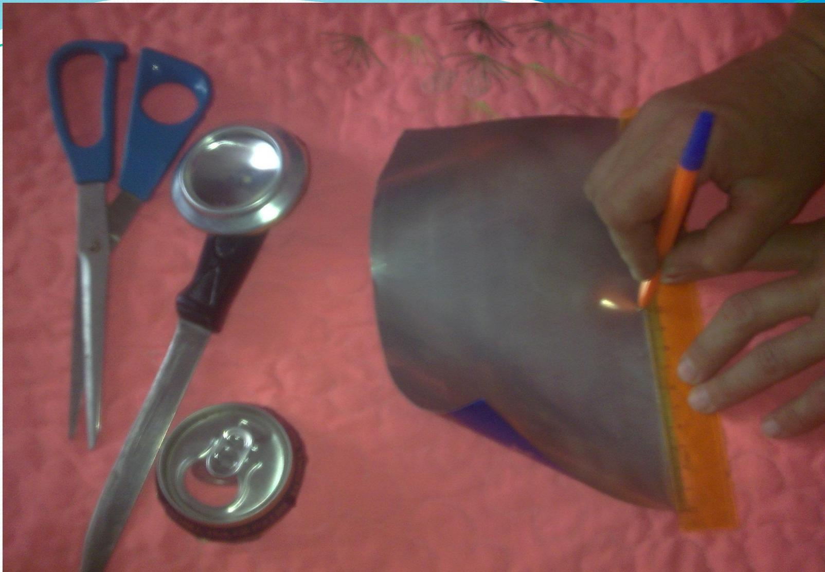
**Делаем разметку: от середины прямоугольника проводим линию на угол**
