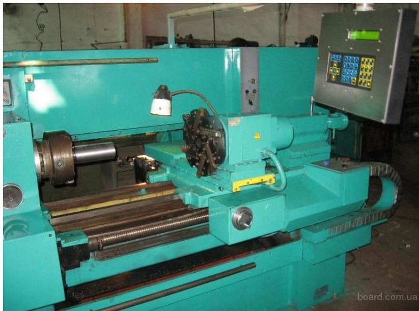
Станок оснащен УЧПУ типа «Электроника НЦ-31» с вводом программы с клавиатуры или внешнего носителя.
