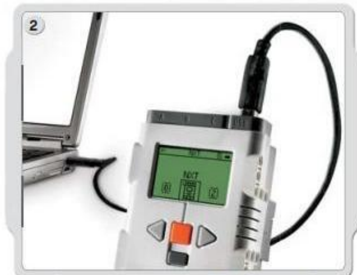
2. Соедините компьютер и NXT кабелем USB.
