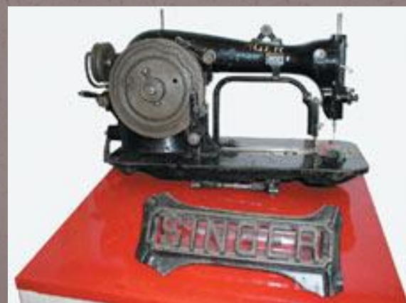
Швейная машина цепного стежка фирмы «Вилькокс и Гиббс» США 1868г.
