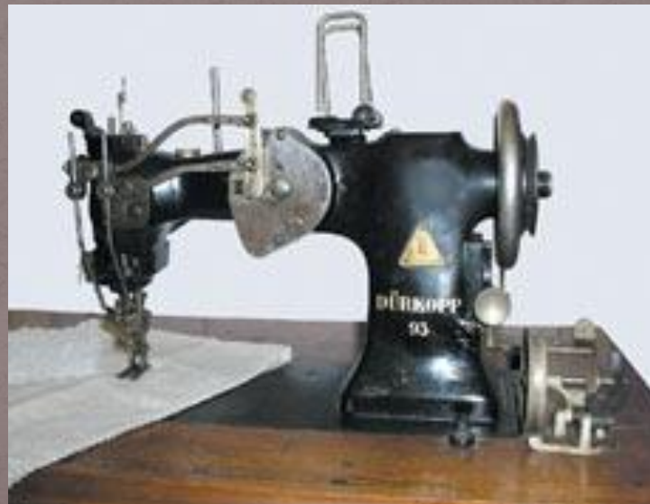
Германия 1900 – 1915гг. Фирма «Дюркопп». Предназначена для выполнения ажурных работ, всевозможных мережек для украшения одежды, столового и постельного белья.
