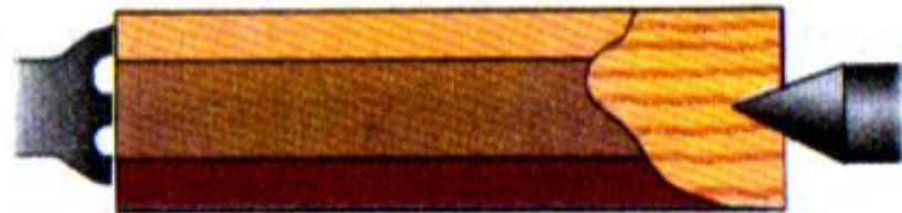
трезубцем с поджатием центром пиноли задней бабки
