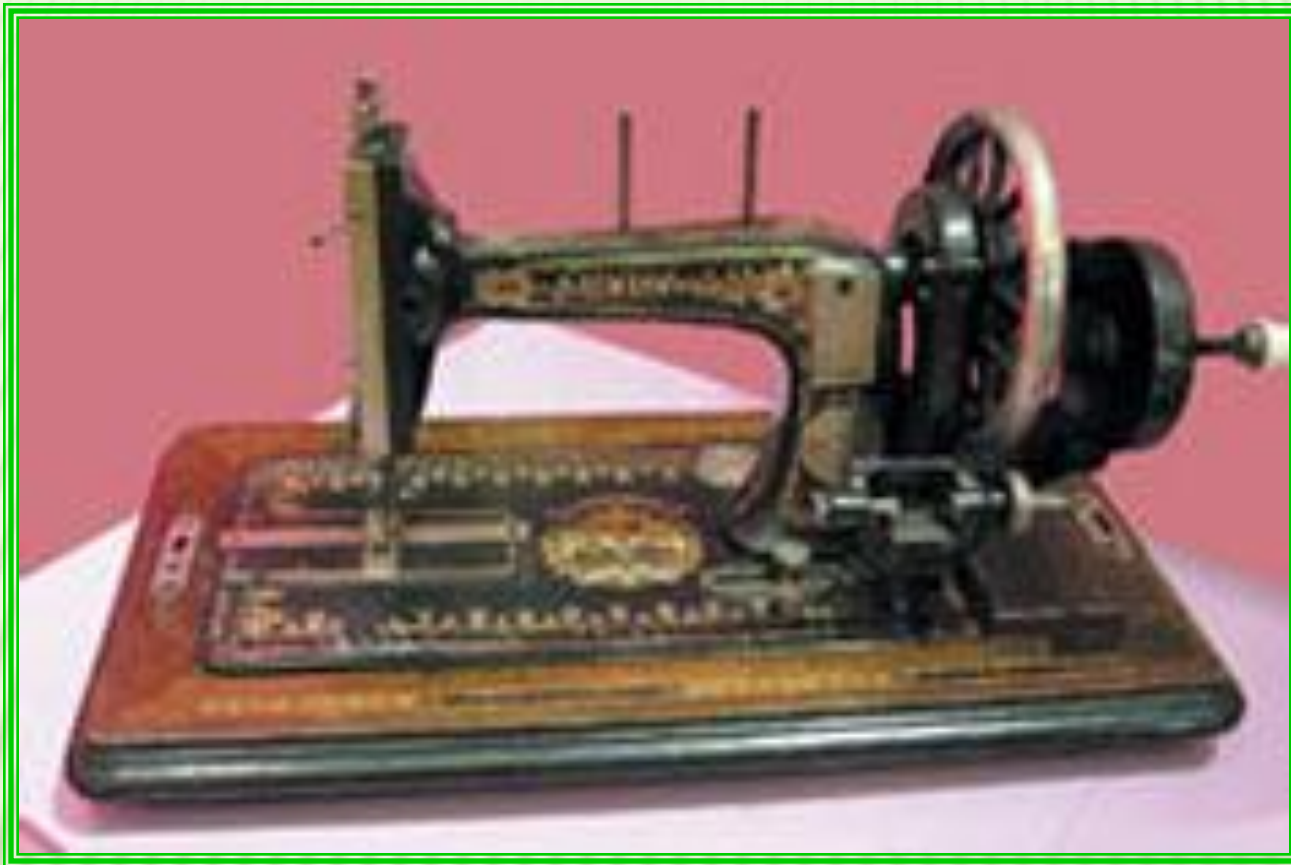
Швейная машина Науманн с ручным приводом
