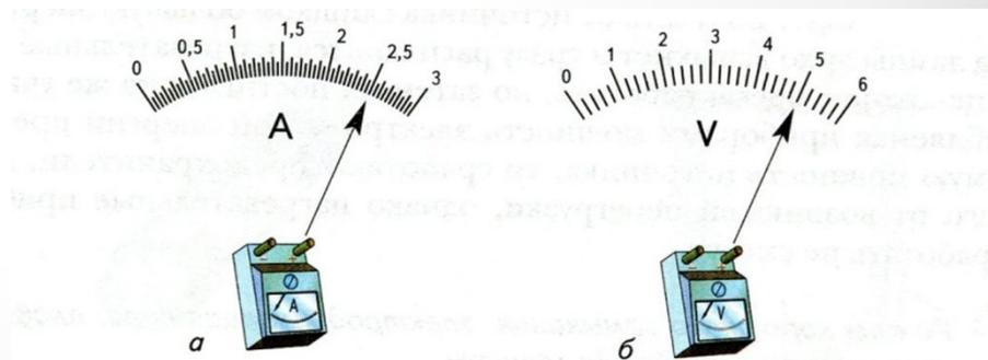
В цепях постоянного тока при включении измерительных приборов учитывают полярность источника тока и приборов. Для облегчения подключения измерительных приборов в электрическую цепь постоянного тока около их клемм указывается полярность.
