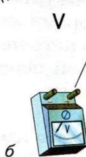
Работа со стрелочными приборами немного осложняется, если приборы имеют несколько пределов измерений. Для изменения предела приборы имеют дополнительные клеммы или переключатель пределов измерения.
