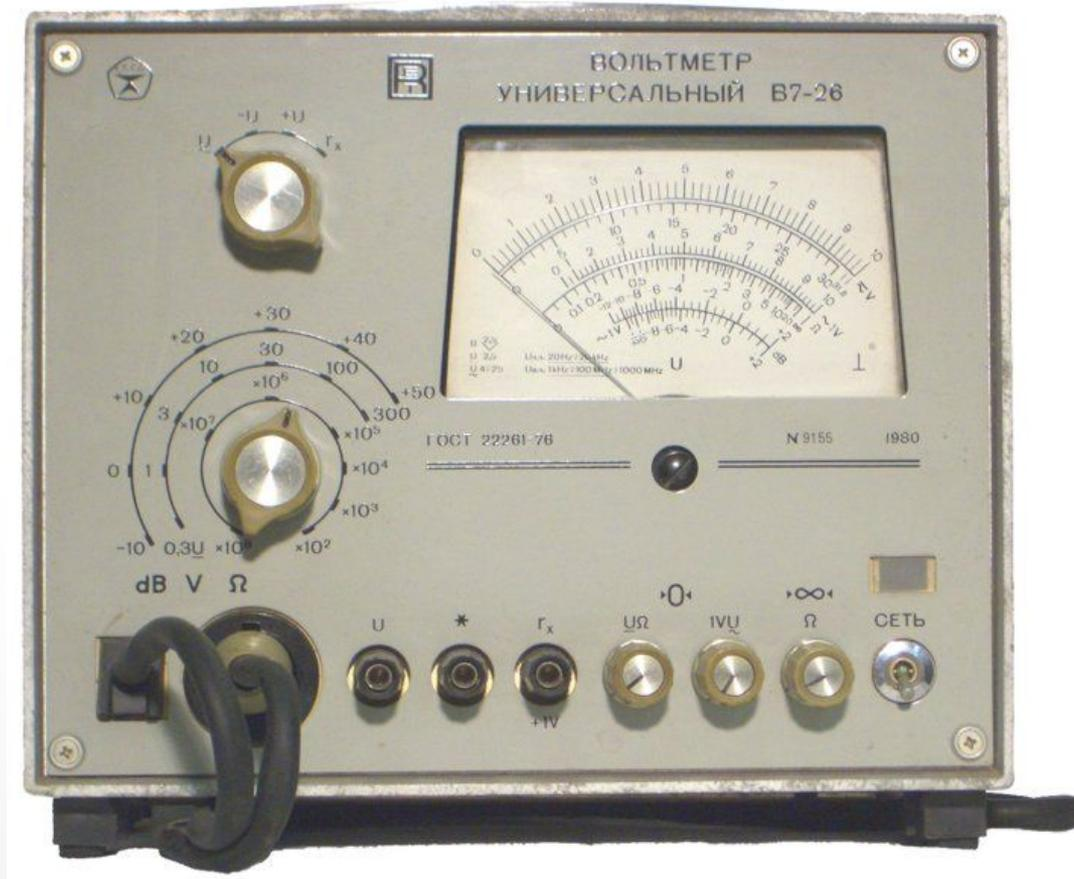
Цена деления прибора определяется по пределу измеряемой величины, делённому на число делений прибора.
