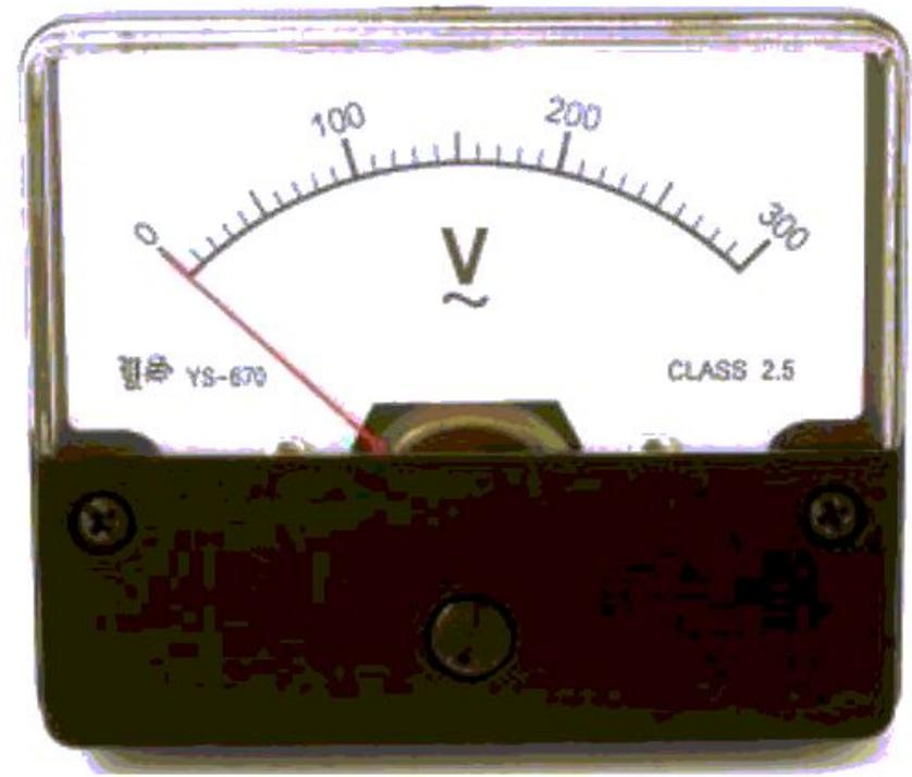
Электроизмерительные приборы бывают двух типов: стрелочные и цифровые. Техника измерений с помощью цифровых приборов достаточно проста: прибор включается в электрическую цепь и на его экране высвечивается измеряемая величина. Не сложно пользоваться и стрелочными приборами с одним пределом шкалы: измеряемая величина определяется по делениям шкалы, на которые указывает стрелка.
