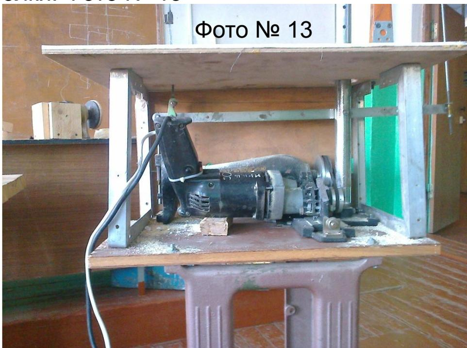
13. Ставим верхнюю карамысло закрепляя на стойку болтом М6.
