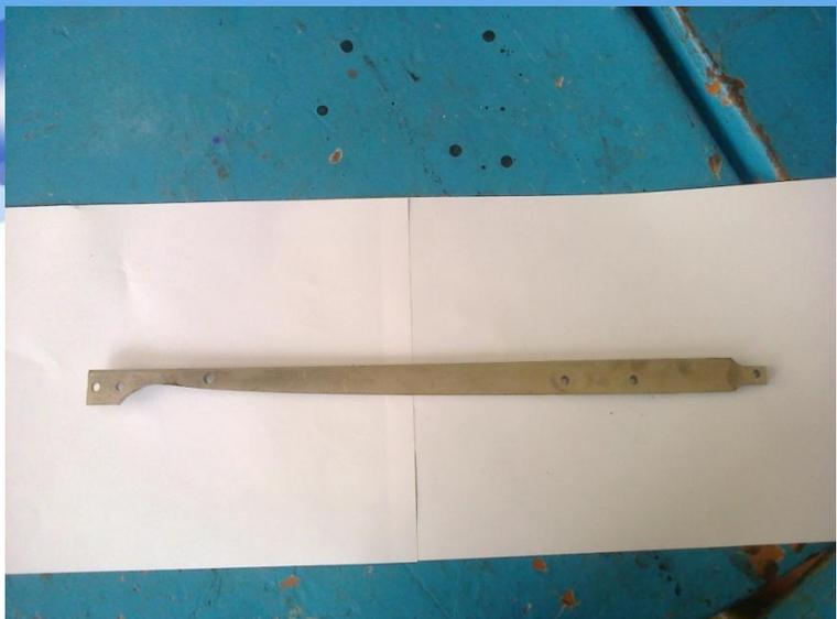
Для изготовления коромысла необходимо две металлические пластинки 600x25x4 мм
