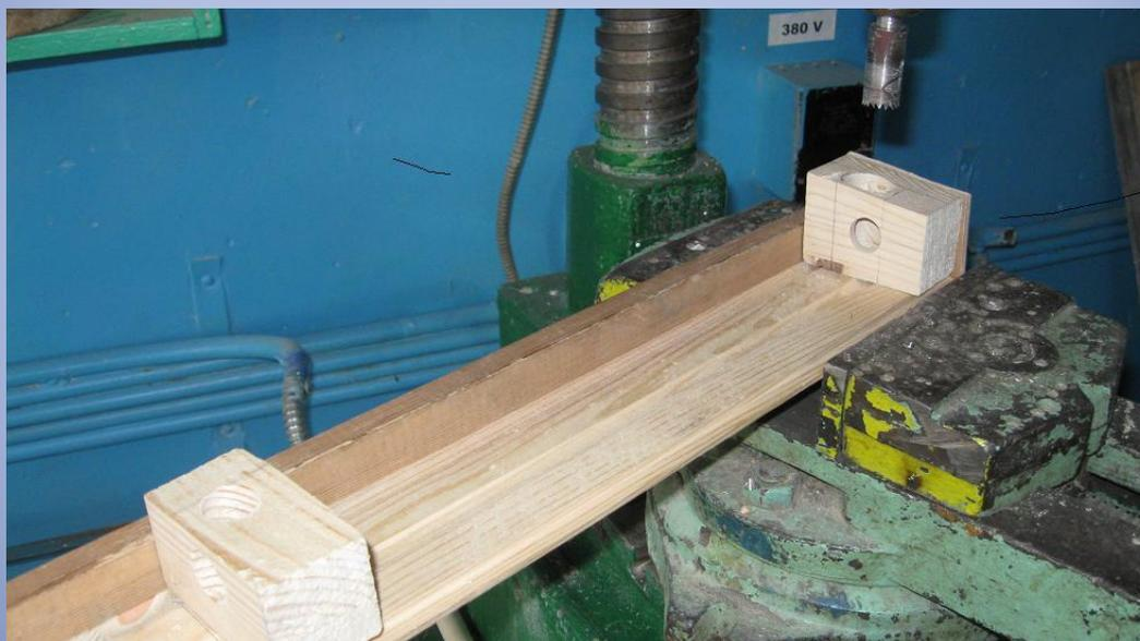
Что бы чашки на бревне были соосны и параллельны противоположная часть бревна фиксируется обрезком шканта. Как указано на фото.
