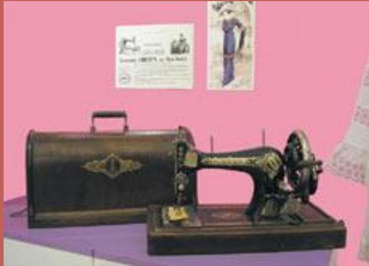
Швейная машина челночного стежка для стачивания тканей (подольский завод компании "Зингер", 1905-1920). Ее корпус имеет так называемую бутылочную форму, которая была запатентована фирмой "Зингер" в конце XIX века. Благодаря сбалансированности всех конструктивных узлов такие машины обладают большим запасом прочности и до сих пор используются во многих домах России.
