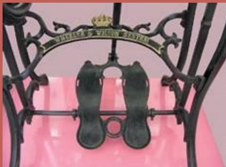
*1854-1865) - один из первых образцов машин челночного стежка. Предназначена для белошвейных работ. Внизу - ее ножной привод.*
