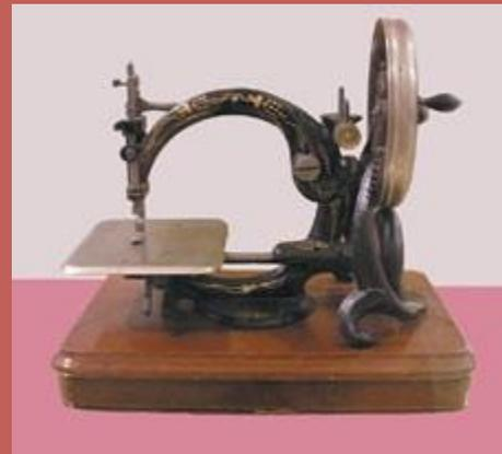
*Вверху - швейная машина двойной строчки с дуговой иглой фирмы "Виллер и Вильсон" (США,*
