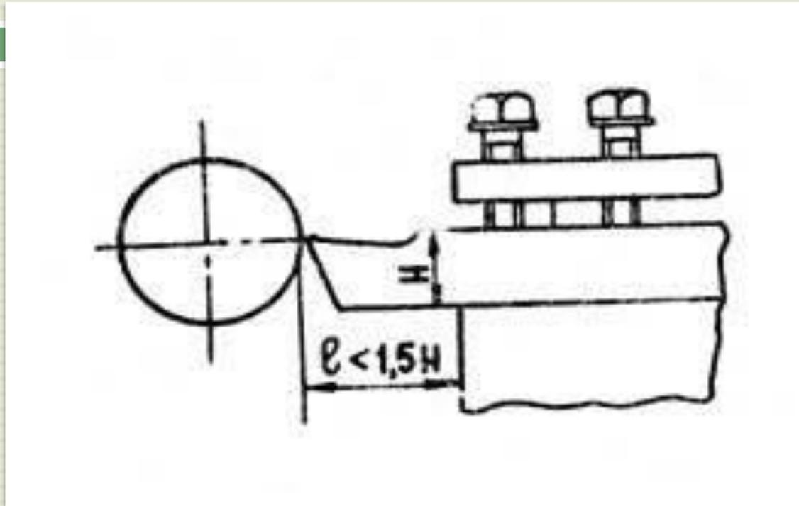
*Вылет резца из резцедержателя не должен превышать полторы высоты державки, т. е.  $l \leq 1,5 H$ . Резец закрепляют в резцедержателе не менее чем двумя болтами.*
