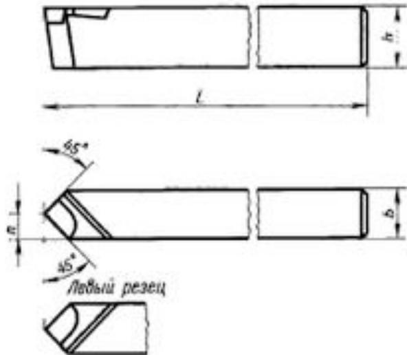
*Прямые — инструменты, у которых державка вместе с их рабочей головкой располагаются на одной оси, либо на двух, но параллельных друг другу.*
