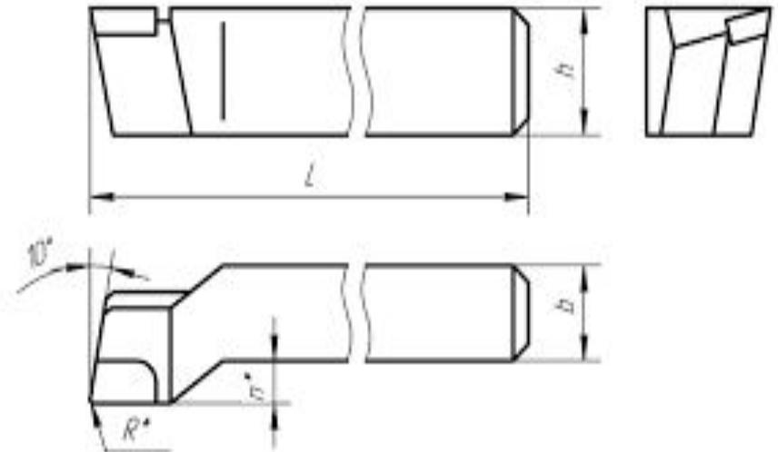
*Отогнутые — отгиб рабочей головки таких инструментов по отношению к оси державки заметен, если посмотреть на них сверху.*
