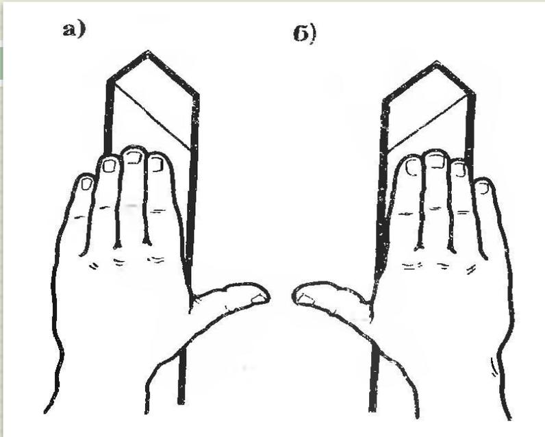
*Для токарной обработки применяют разнообразные резцы. В зависимости от направления движения подачи различают левые и правые резцы.*
