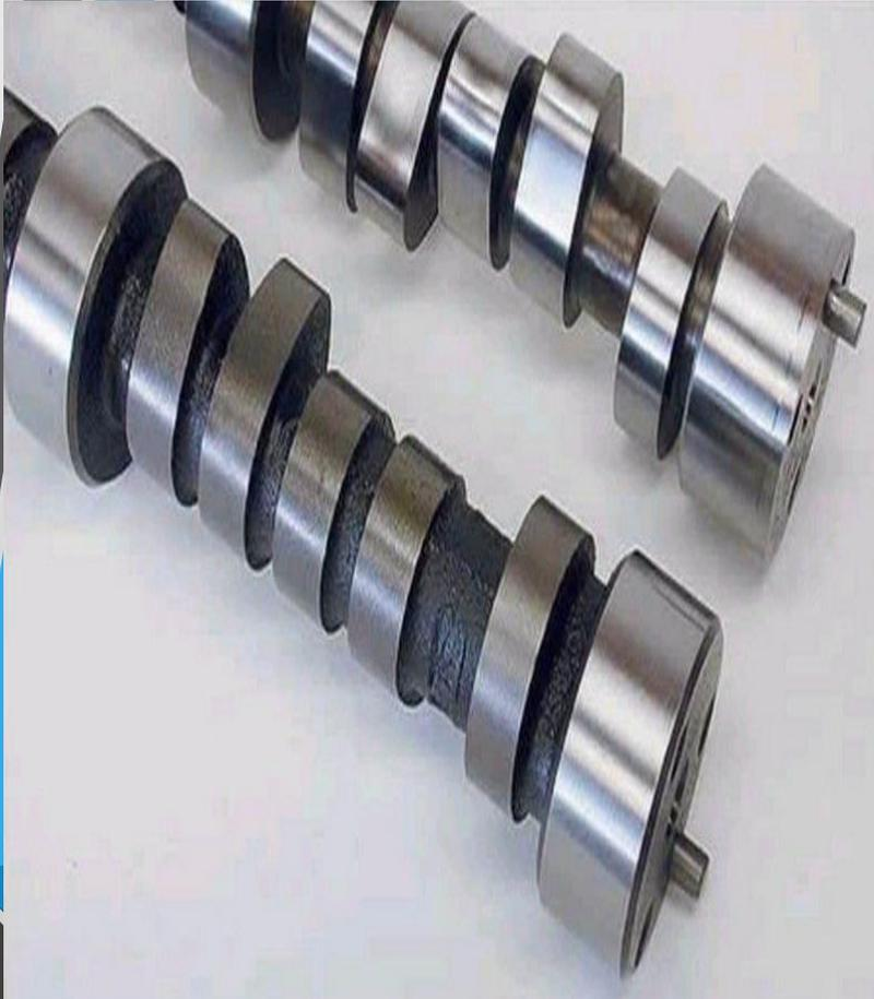
На распредвале находятся опорные шейки и кулачки для открытия выпускных и впускных клапанов.
