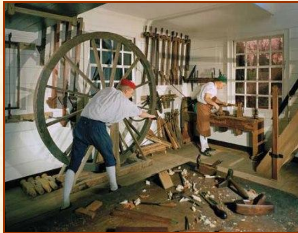
Токарный станок с канатным ручным приводом от маховика
