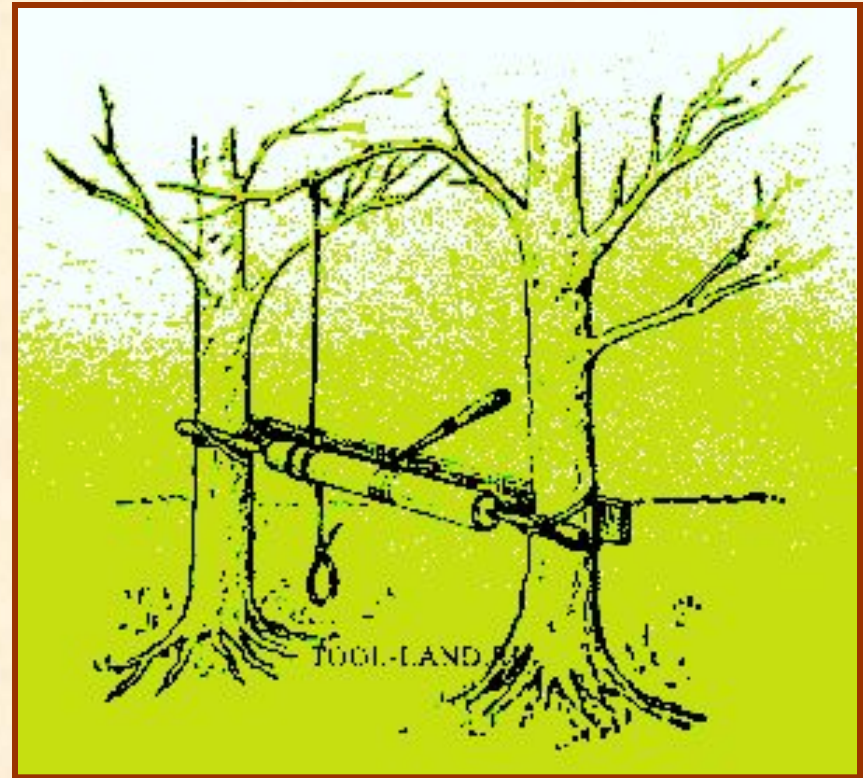
Токарный станок с ножным приводом
