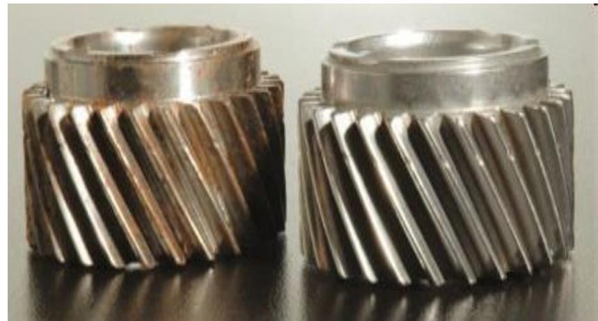
Процесс струйной гидроабразивной обработки (ГАО) заключается в направлении струи супензии, состоящей из воды и частиц абразивных материалов, на обрабатываемую поверхность заготовки
