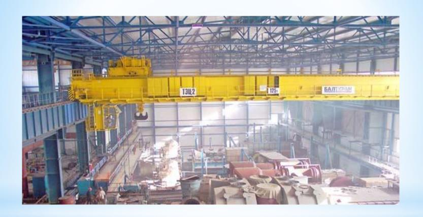
Мостовые краны подвесные двухбалочные многоопорные предназначены для транспортирования крупногабаритных изделий. Пролеты этих кранов не более 96 м. Кран оборудован двумя тележками с двумя механизмами подъема грузоподъемностью до 20 т.
