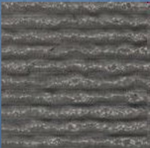
д) точечная фактура – равномерно шероховатая поверхность с точечными углублениями и высотой рельефа 0,5÷2 мм. Обрабатывают поверхность гранита, сиенита, габбро, диабаза.
