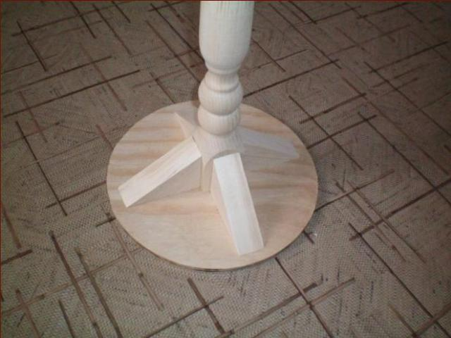
Для прочности и устойчивости крепим деревянные уголки при помощи гвоздей.
