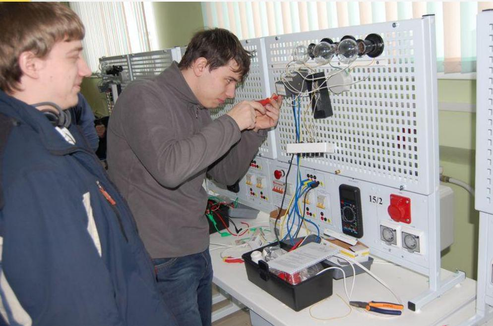
Работы на электромонтажном стенде призваны выработать у учащихся навыки проведения монтажа электропроводки, а также промышленных шкафов управления. Учащиеся самостоятельно монтируют требуемую электрическую схему, а именно: проводят монтаж электрических компонентов; соединяют их между собой проводами (согласно электрической схеме); проверяют работоспособность собранной схемы.
