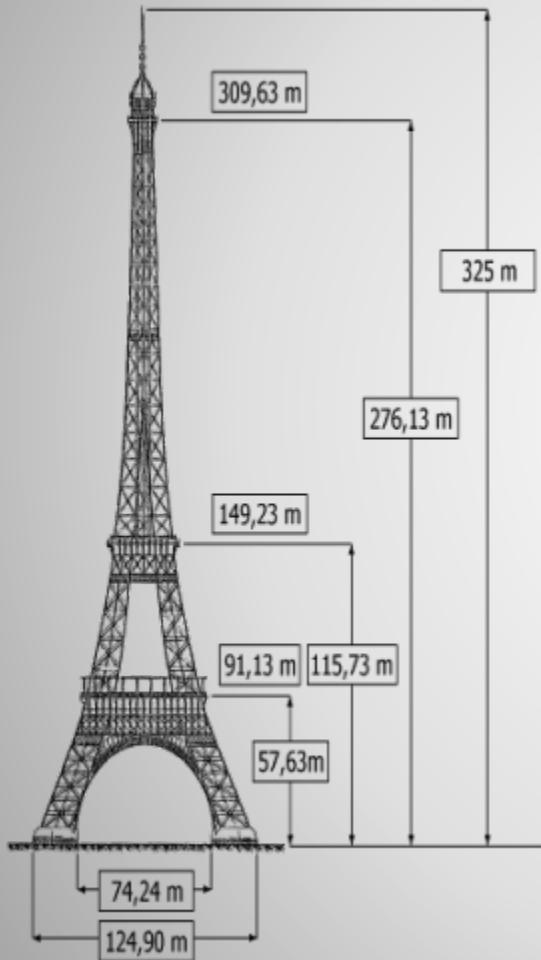
Вес металлической конструкции — 7 300 тонн (полный вес 10 100 тонн). Фундамент выведен из бетонных массивов. Колебания башни во время бурь не превышают 15 см.
