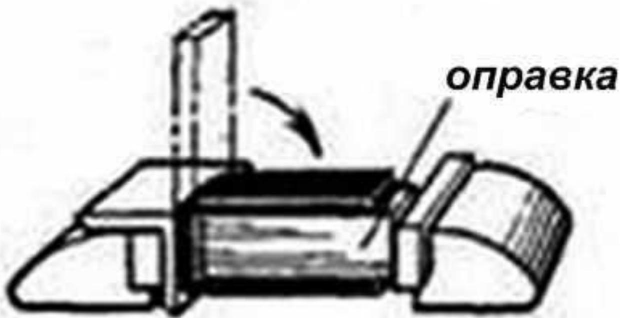
9. Снять заготовку, разметить длину коротких полок. Провести риски, отложив размер 21 мм от каждого конца.
