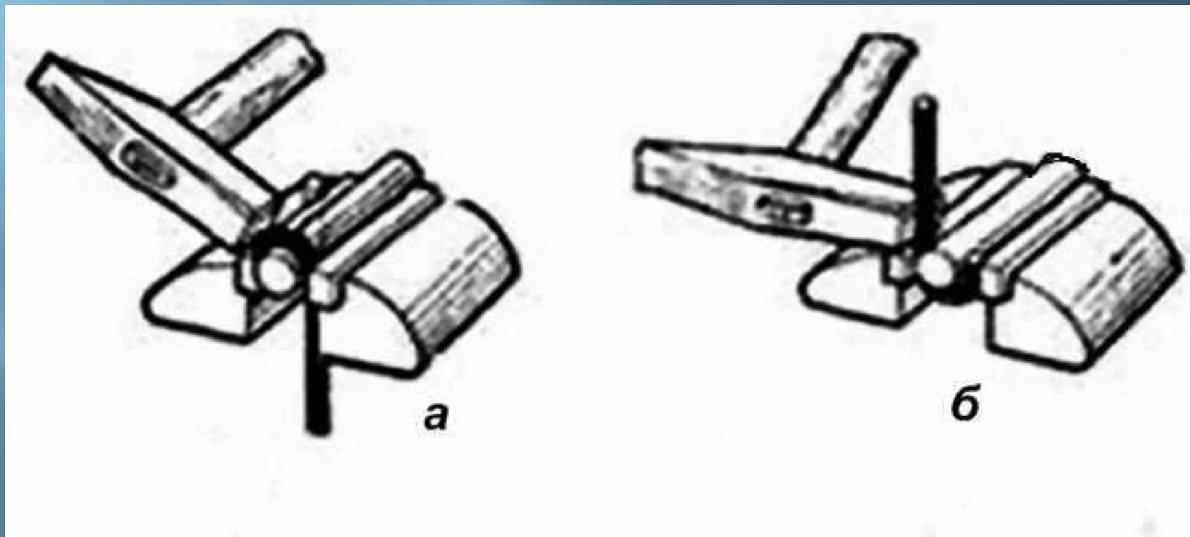
7. Не вынимая оправки из кольца, заготовку переставить в тисках и ударом молотка по стержню подогнуть его, придавая ему правильное положение; оси кольца и стержня должны совпасть.
