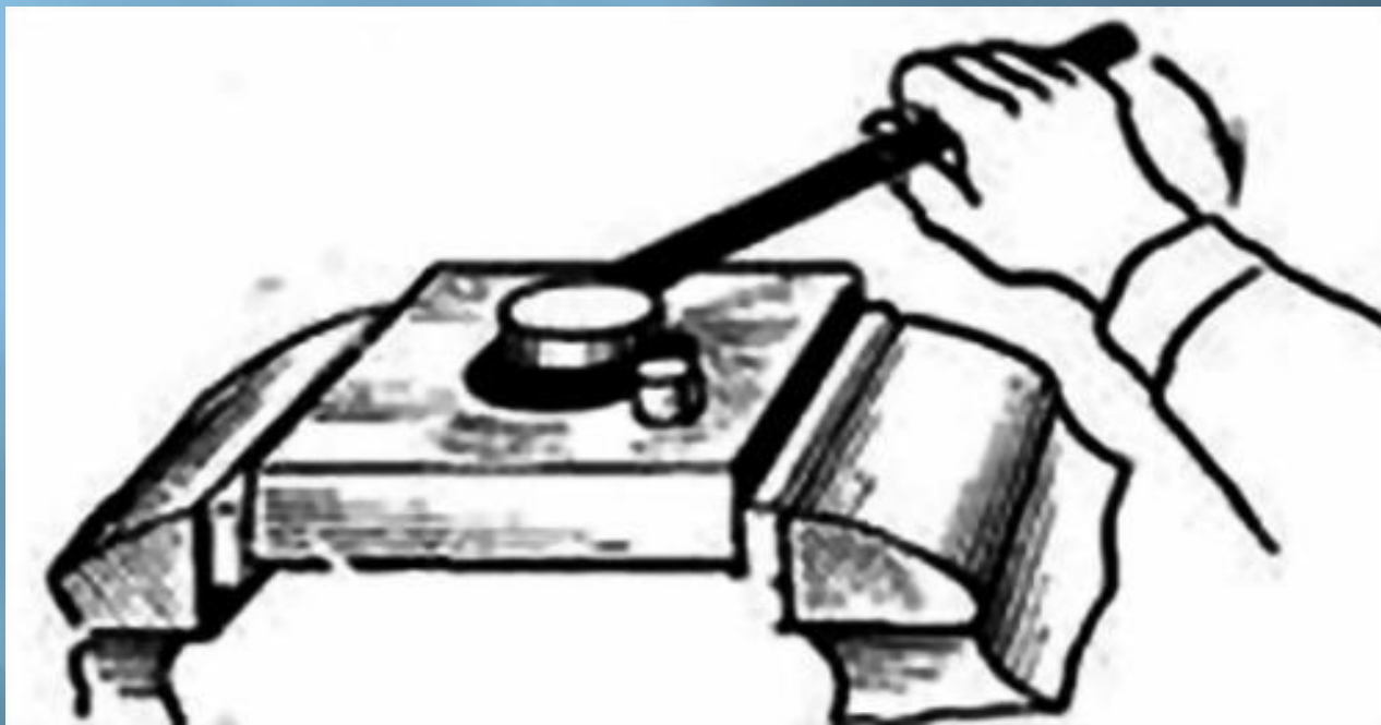
Рис. 4.3. Гибка прутка круглого сечения в приспособлении
