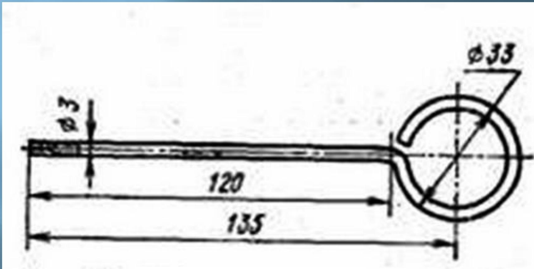
1. Определить общую длину заготовки согласно чертежу:
