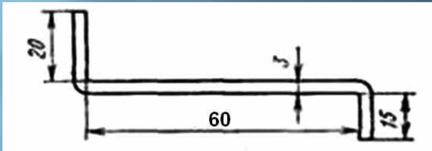
1. Определить длину заготовки согласно чертежу:
