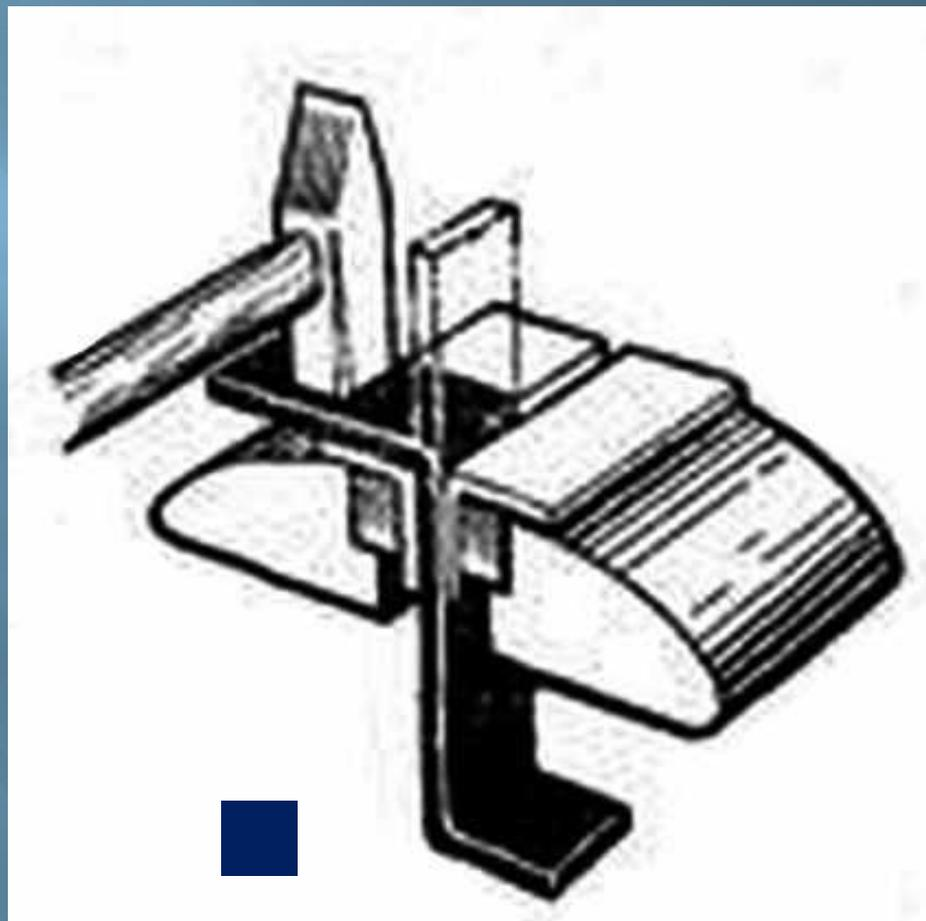
11. Качество гибки проверяем на глаз, углы — слесарным угольником, размеры — линейкой.
