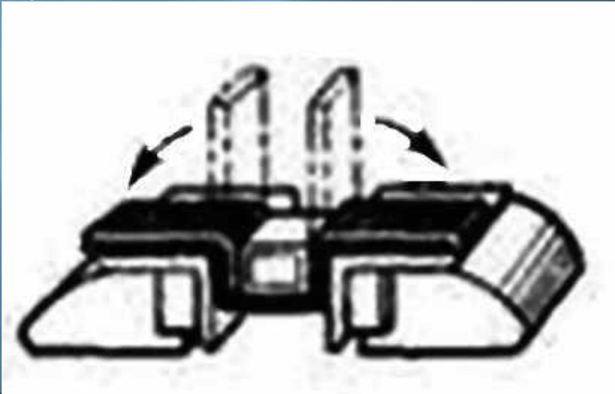
11. Качество гибки проверяем на глаз, размеры – линейкой, углы – слесарным угольником; отклонение от плоскости полок проверить на поверочной плите.
