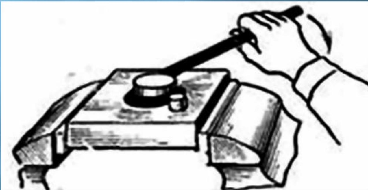
Рис. 4.3. Гибка прутка круглого сечения в приспособлении
