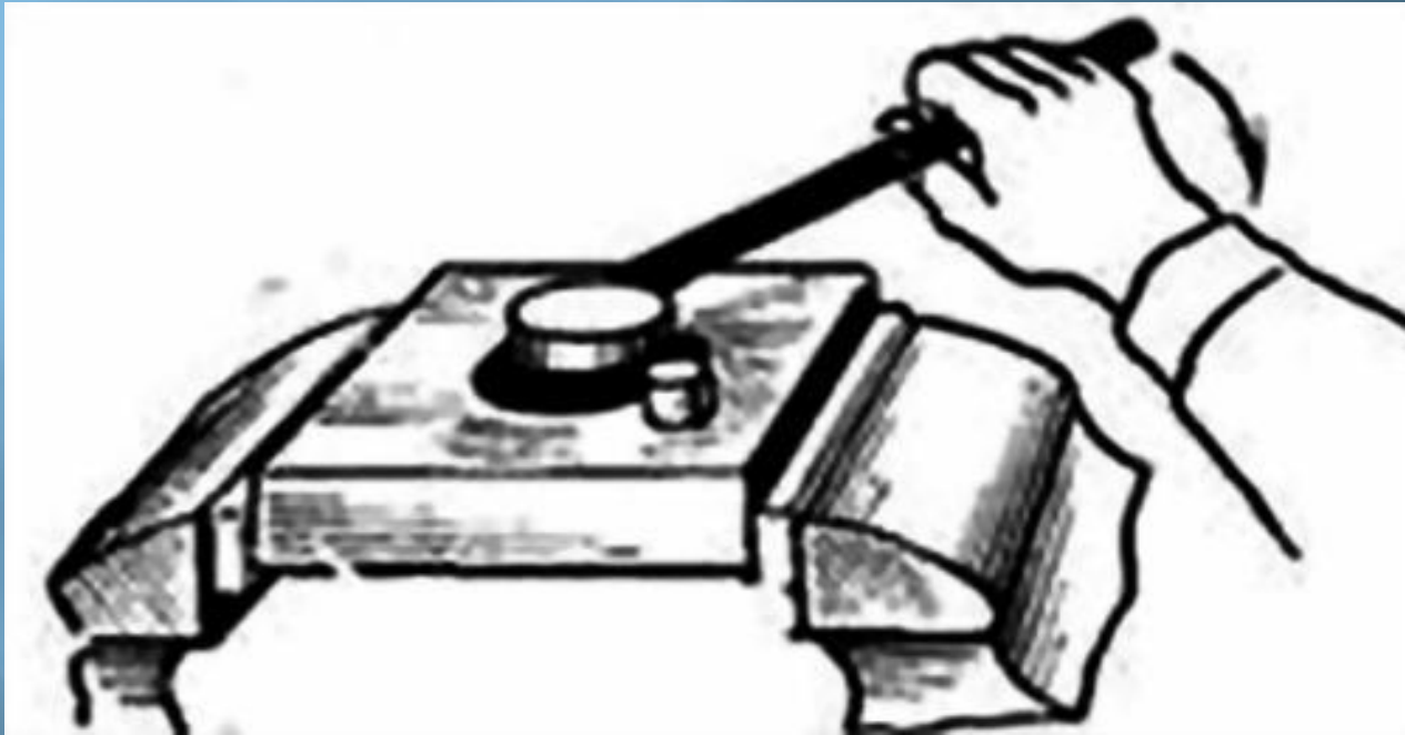
Рис. 4.3. Гибка прутка круглого сечения в приспособлении
