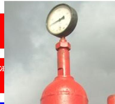
Если в момент опрессовки не наблюдается утечек жидкости и давление в течении 3-х минут остаётся неизменным то линия считается герметичной.
