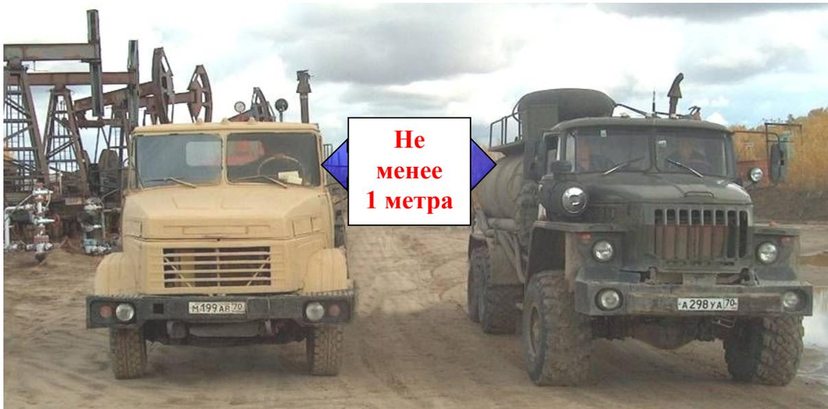
Расстояние **между насосным агрегатом и цистерной** с раствором должно быть **не менее 1 метра**.
