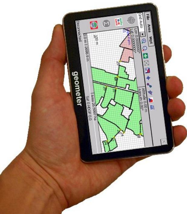
Измерение площади полей в режиме реального времени, отображение контура измеряемого участка и расчет параметров: площадь, периметр длина.
