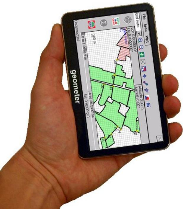
Портативное GPS устройство было специально разработано для быстрого и точного измерения площади сельскохозяйственных полей любой геометрии и размера, с возможностью выставления специальных отметок на местности.
