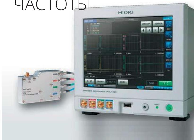
Предназначен для наблюдений и измерений параметров иммитанса радиоэлектронных компонентов в диапазоне частоты от 1 МГц до 1300 МГц. Функциональные возможности измерений анализатора наилучшим образом подходят для производственных линий
