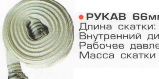
• РУКАВ 66мм «СТАНДАРТ» Длина скатки: 20 ± 1м. Внутренний диаметр: 66 + 2мм. Рабочее давление: 1,6Мпа. Масса скатки не более: 11кг.
