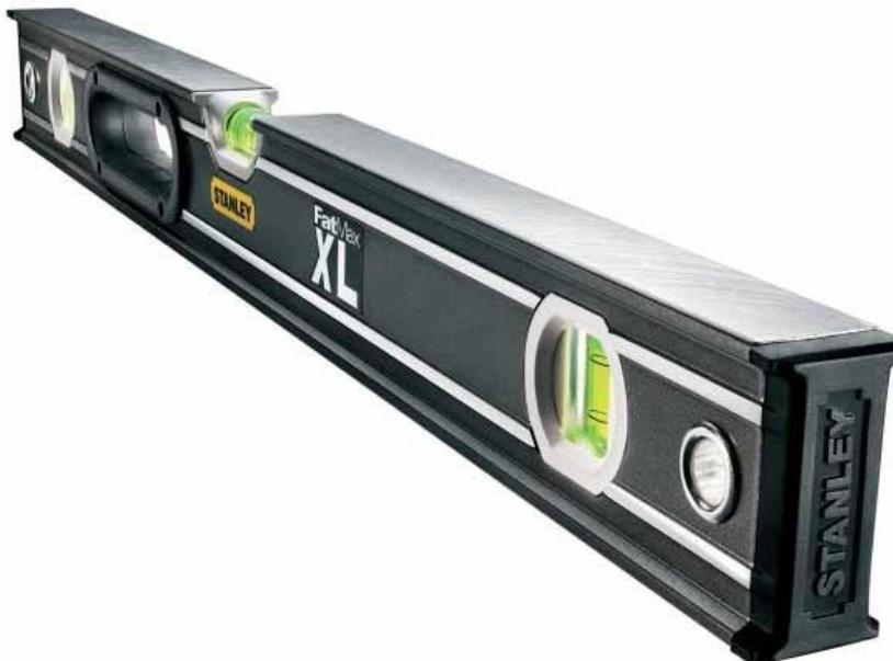
□ Служит для проверки горизонтальности и вертикальности кладки. На корпусе уровня закреплены две стеклянные трубки-ампулы, изогнутые по кривой большого радиуса, наполненные незамерзающей жидкостью так, что в них остается небольшой воздушный пузырек.
