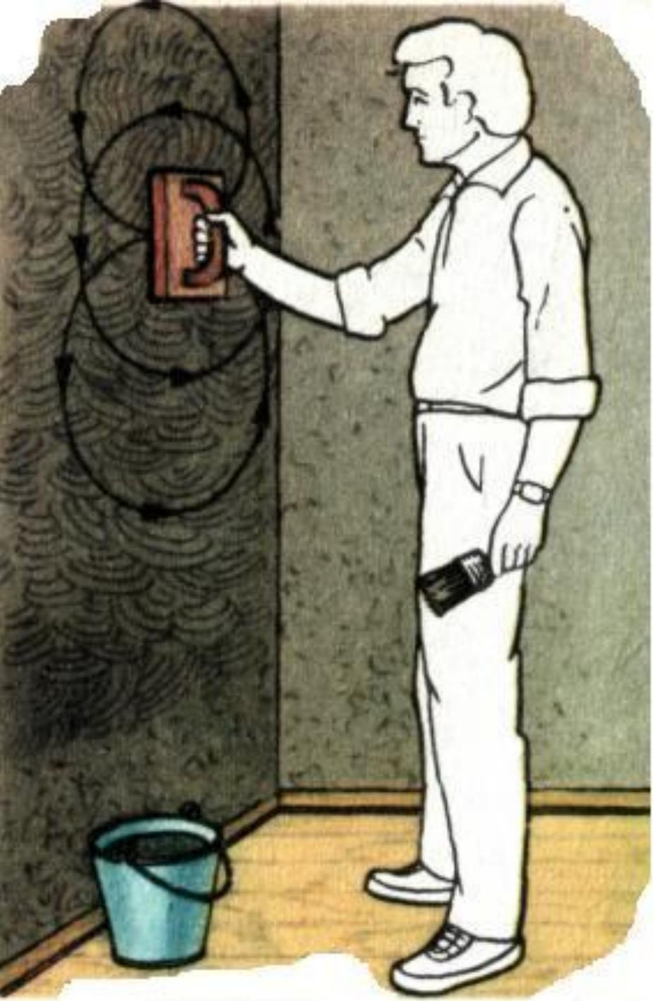
Затирання виконують тоді коли розчин ще не затужав і затирається теркою без попереднього змочування водою. При затиранні “Вкругову” терку беруть правою рукою прижимають полотном до штукатурки і виконують нею кругові рухи проти годинникової стрілки. При цьому бугорки розчину зрізуються , а ямки заповнюються розчином.
