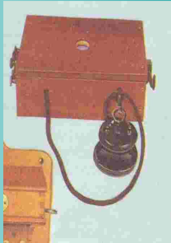
Телефон Эдисона (1879). Сушащий вращал ручку аппарата
