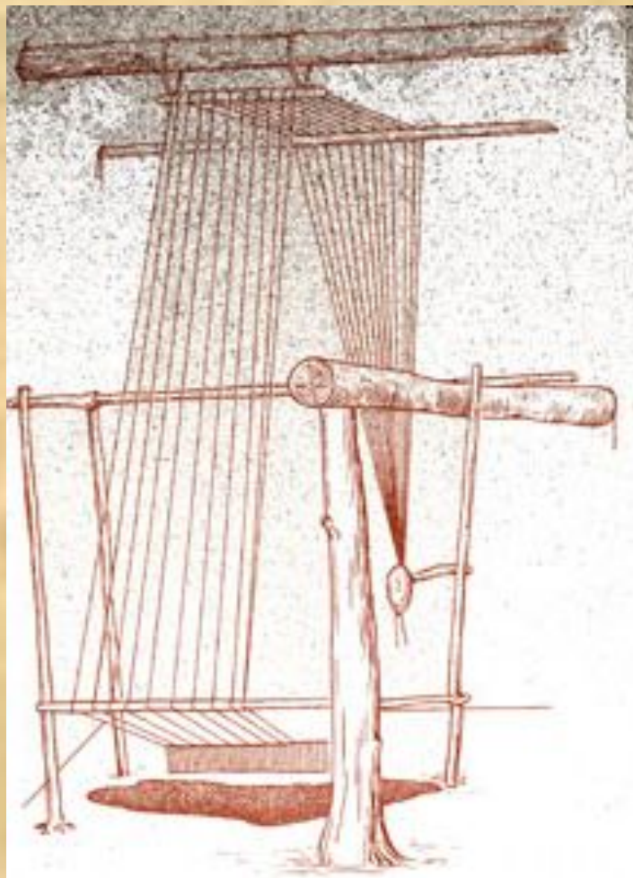
Горизонтальный станок с ямой для подножек и грузом, подвешенным к запасу основы (50-е годы XX века, Сирия)
