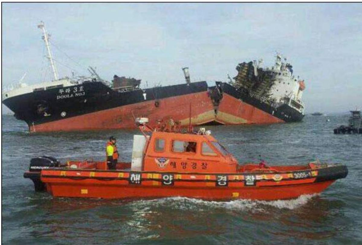
**105 метровый 6535 тоннажный танкер Doola 3 взорвался возле острова Jawol, Южная Корея . Танкер разорвало взрывом одной из порожних цистерн. Взрыв разломил судно пополам**
