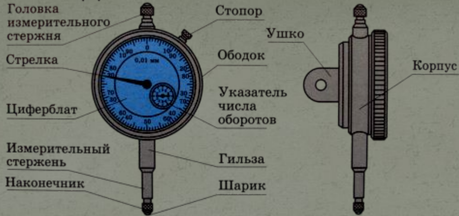
Измерение индикаторной скобой
