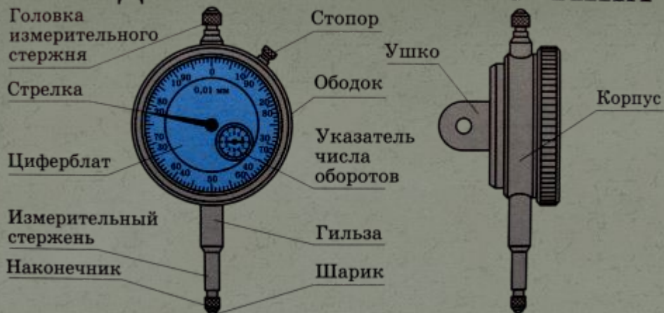
Измерение индикаторной скобой
