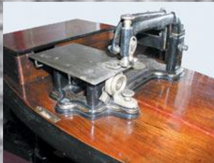
швейная машина двойной строчки с дуговой иглой фирмы „Виллер и Вильсон“ (США, 1854-1865) — один из первых образцов машин челночного стежка.
