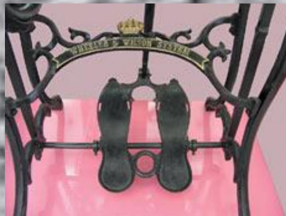
швейная машина двойной строчки с дуговой иглой фирмы „Виллер и Вильсон“ (США, 1854-1865) — один из первых образцов машин челночного стежка.
