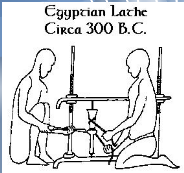
Древнеегипетский токарный станок приблизительно 300 век до нашей эры*
