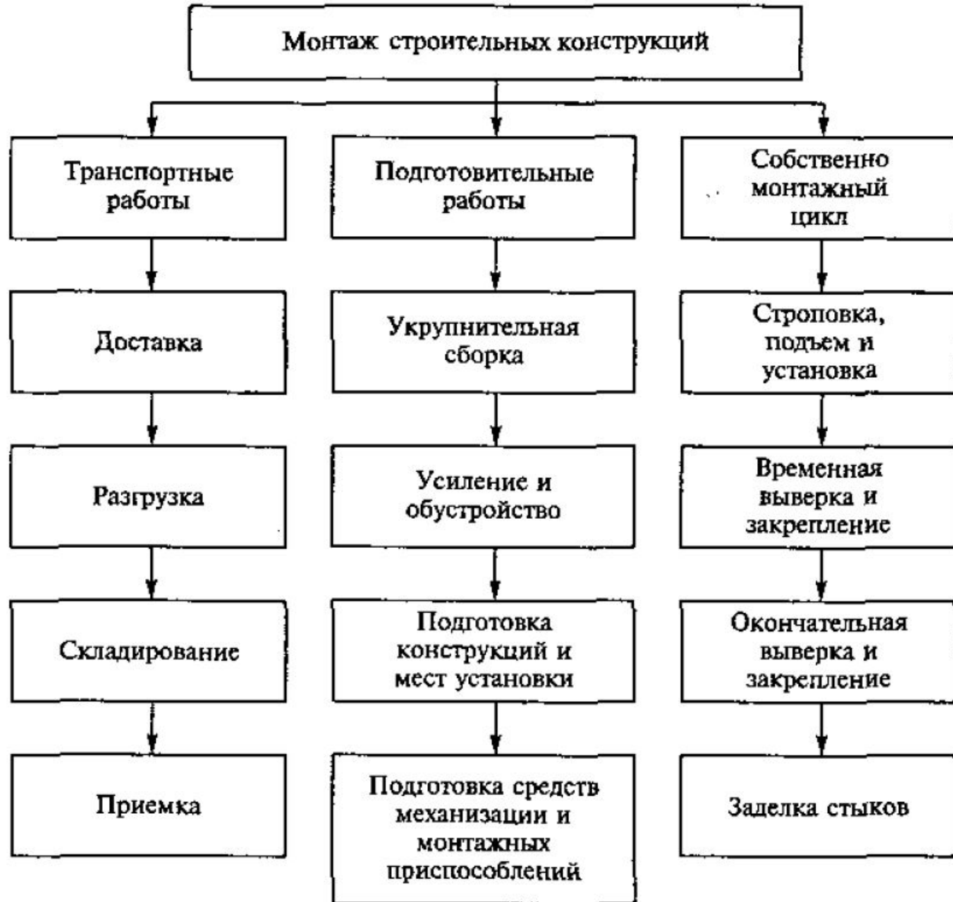
Схема технологического процесса монтажа строительных конструкций
