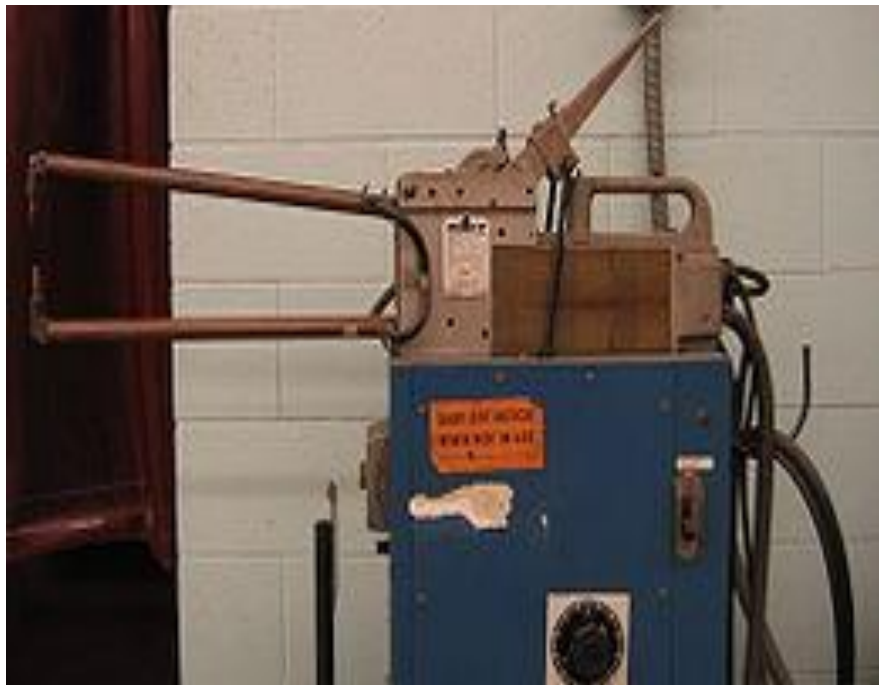
Установка для контактной точечной сварки
