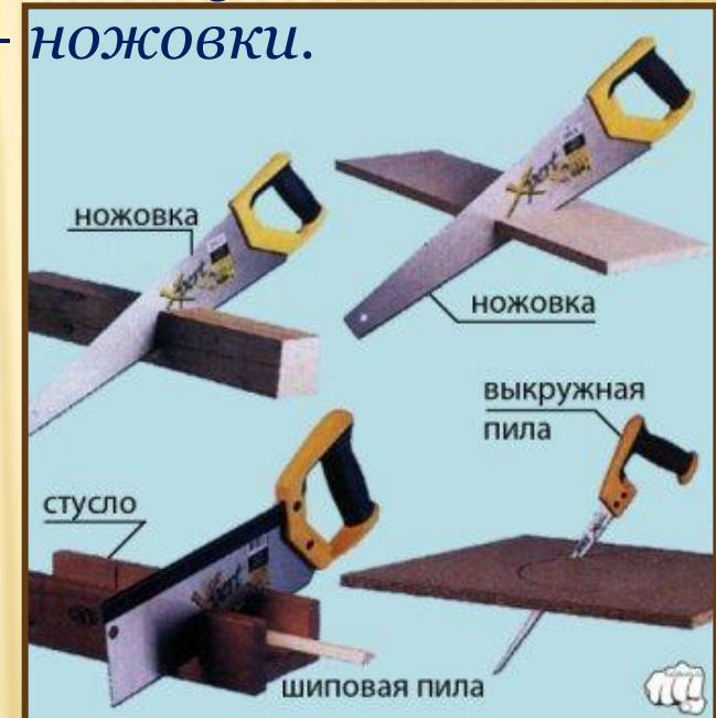
**Ручные пилы:** а – широкая ножовка; б – узкая ножовка (выкружная); в – ножовка-измеритель; г - ножовка с обушком (шиповая); д - наградка; е – лучковая пила: 1 – пильное полотно; 2 – стойка; 3 – тетива; 4 – закрутка; 5 – распорка; 6 – ручка.
