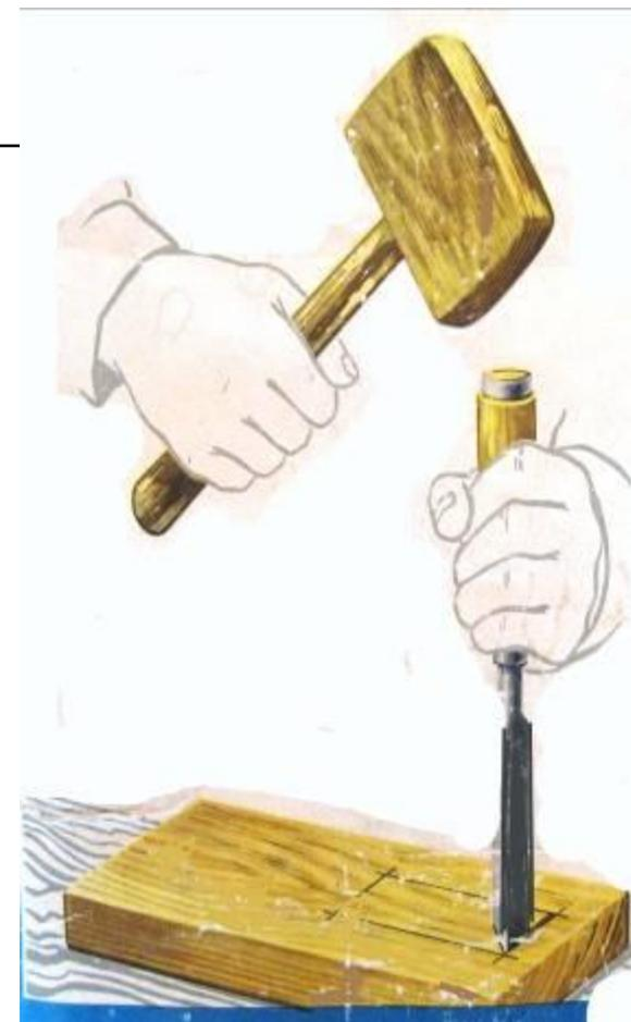
Долбление производится с предварительной точной разметкой. Сквозные гнезда размечают с обеих сторон детали. Параллельно разметочным рискам, отступя от них внутрь гнезда на 1—1,5 мм, полезно сделать по всему контуру гнезда углубленные риски при помощи стамески.
