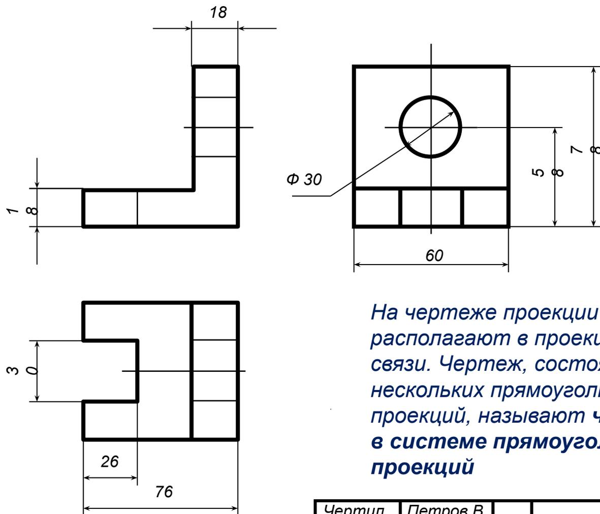
*На чертеже проекции располагают в проекционной связи. Чертеж, состоящий из нескольких прямоугольных проекций, называют **чертежом в системе прямоугольных проекций***
