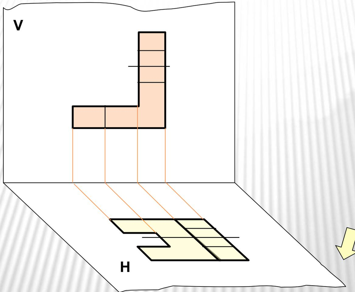
Построенные проекции оказались расположенными в пространстве в разных плоскостях (вертикальной и горизонтальной). Для получения чертежа предмета обе плоскости совмещают в одну, развернув плоскость *H* вниз на 90 градусов.
