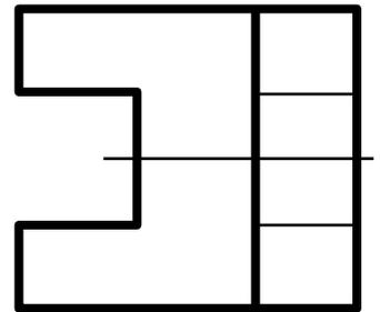
Получившийся таким образом чертёж содержит три прямоугольные проекции предмета: **фронтальную, горизонтальную и профильную**. Оси проекций и проецирующие лучи на чертеже не показываются
