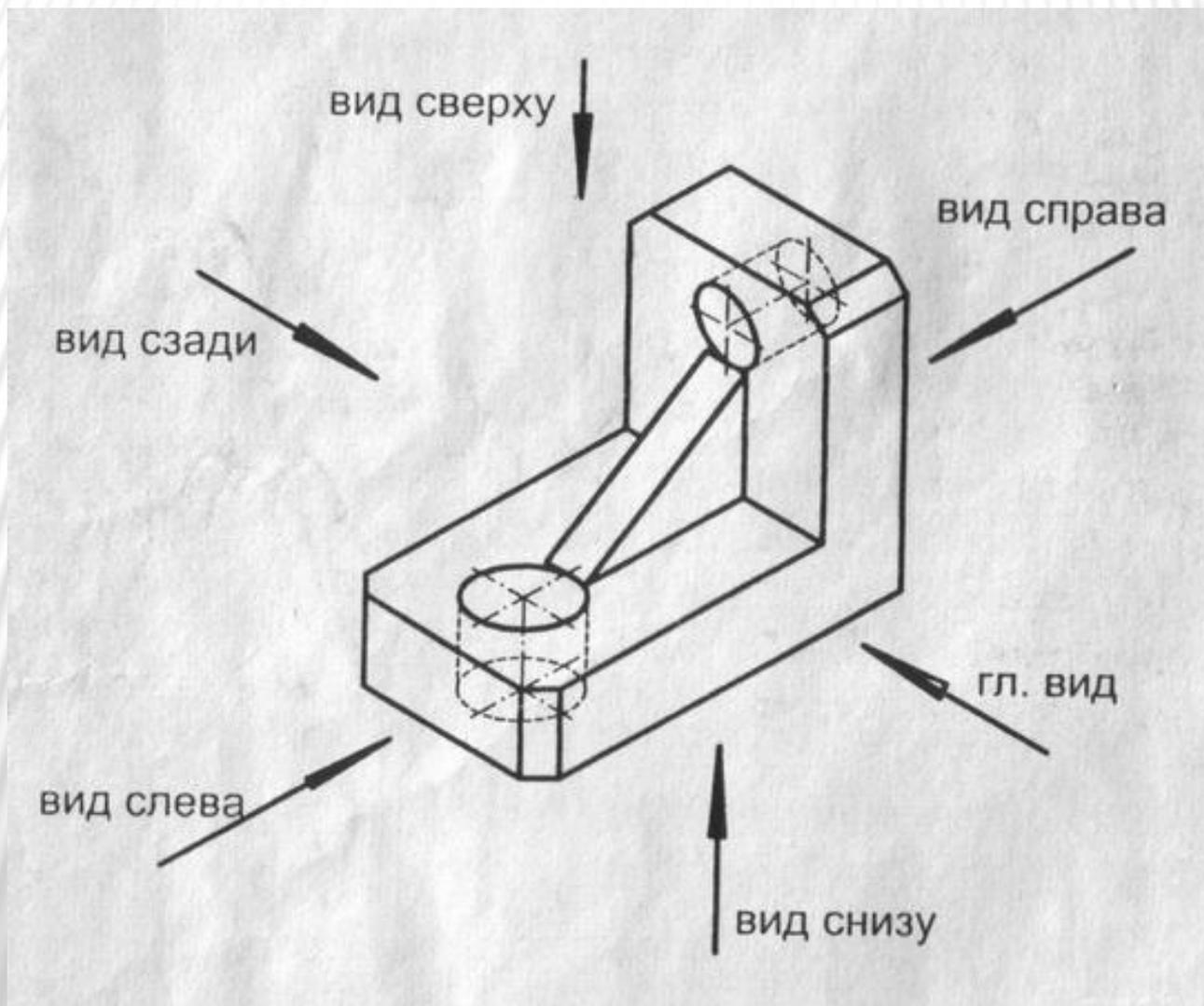
Спереди! Изображение на фронтальной плоскости проекций V-
