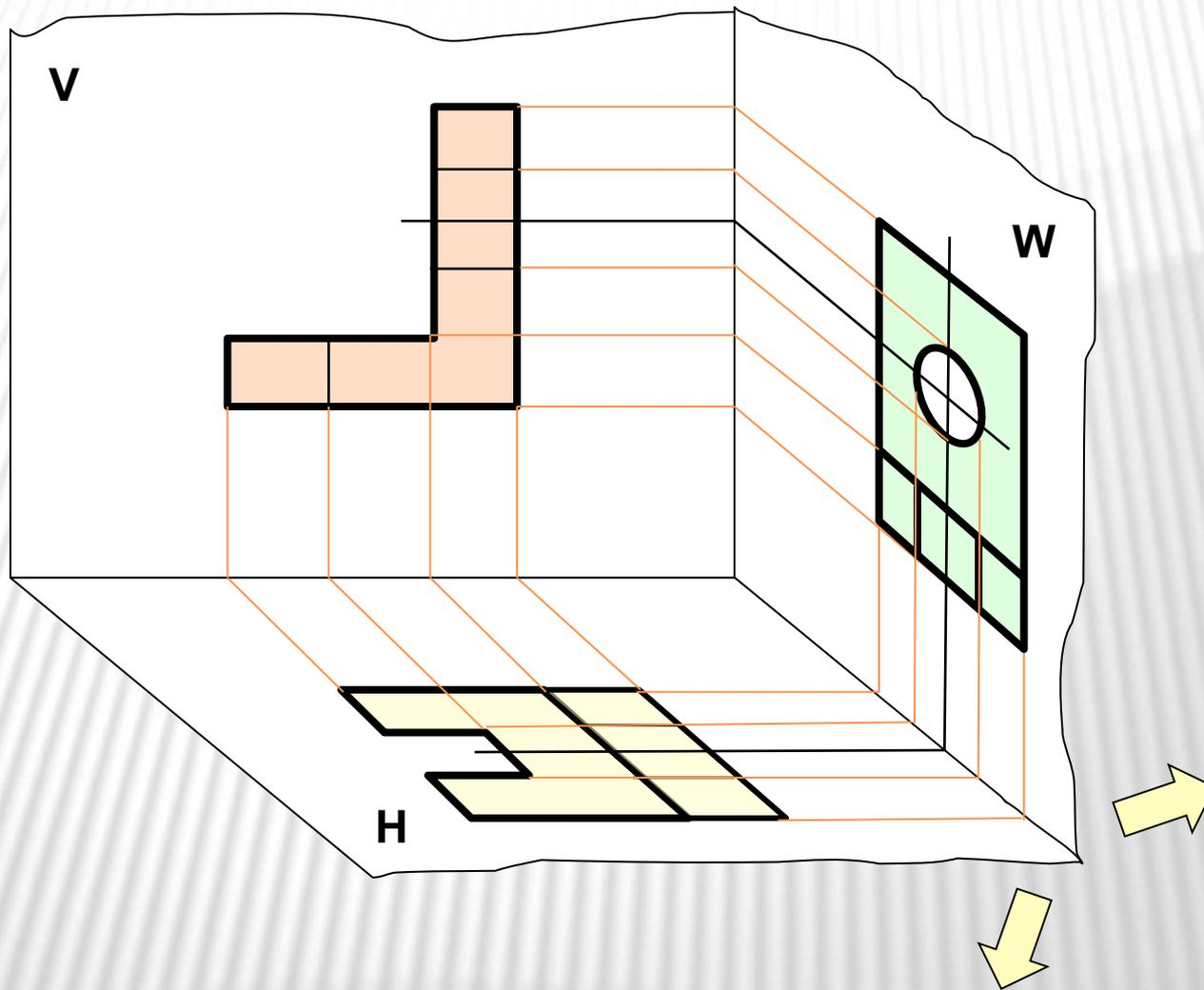
Для получения чертежа предмета плоскость  $W$  поворачивают на  $90^\circ$  вправо, а плоскость  $H$  на  $90^\circ$  вниз
