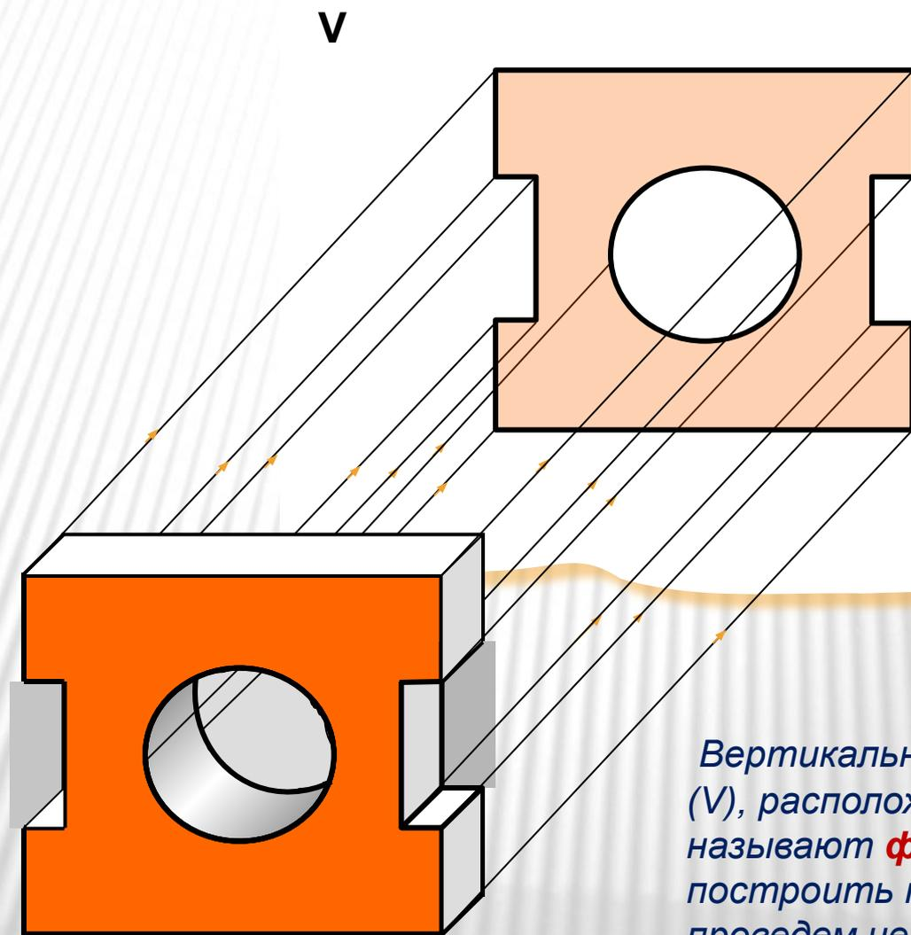
Вертикальную плоскость проекций (V), расположенную перед зрителем, называют **фронтальной**. Чтобы построить проекцию предмета, проведем через вершины и точки отверстий предмета проецирующие лучи, перпендикулярные плоскости V
