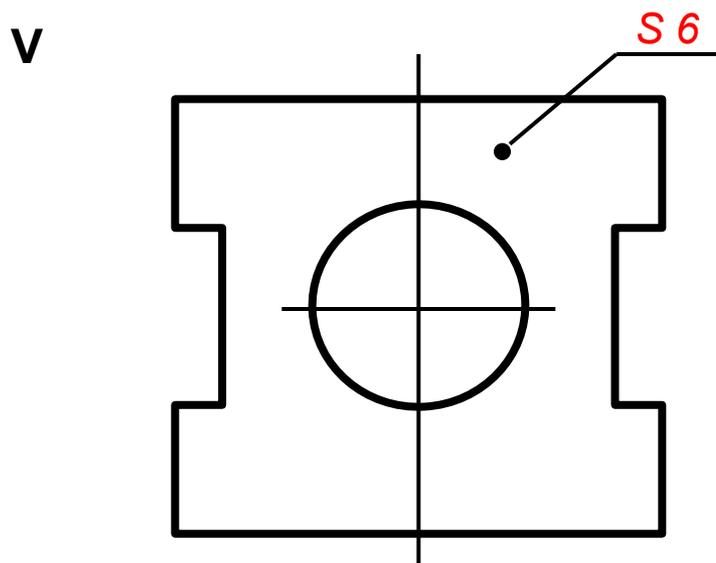
*По полученной проекции мы можем судить о двух измерениях предмета – высоте и ширине. Чтобы по такому изображению можно было судить о форме плоской детали, его дополняют указанием толщины (**S**) детали*
