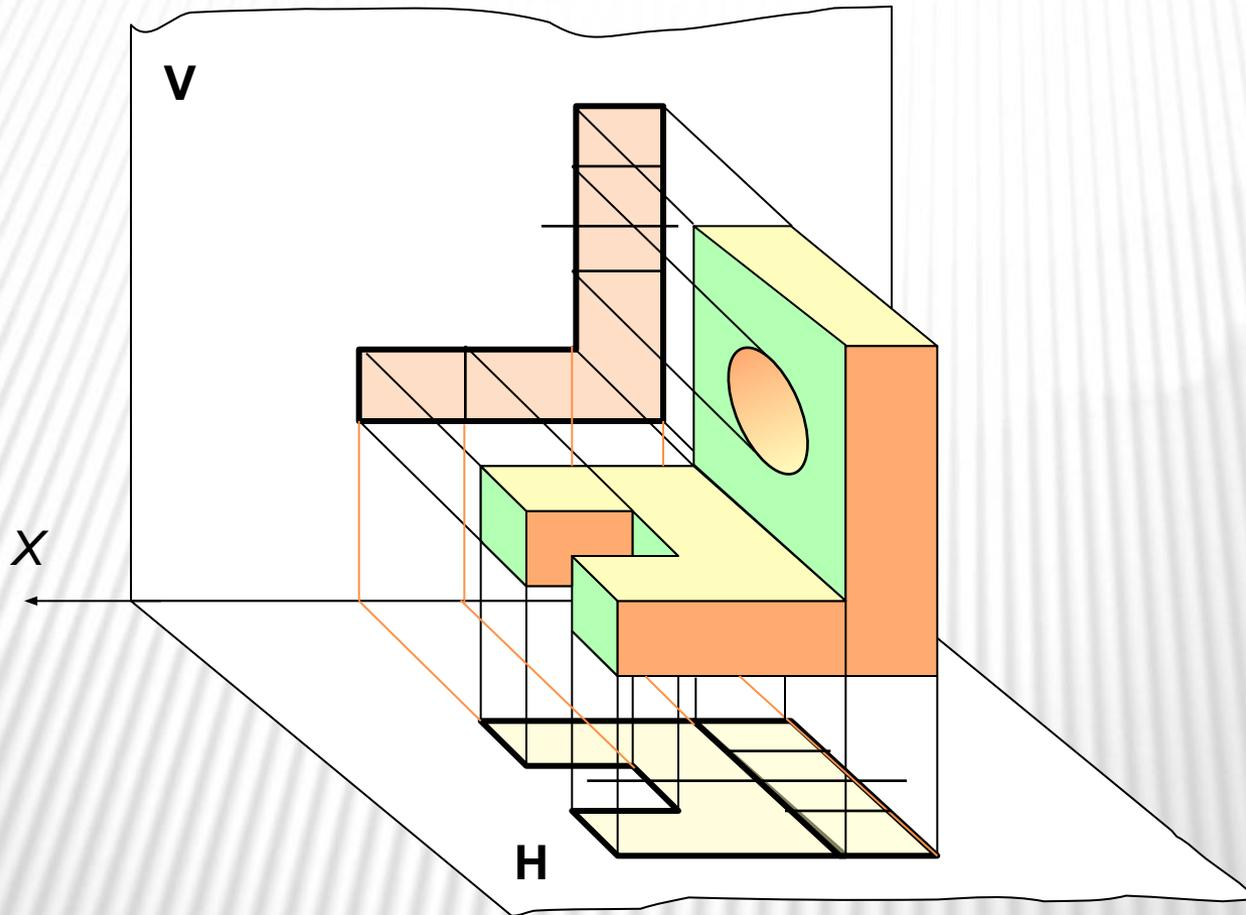
Одна проекция не всегда определяет геометрическую форму предмета.
