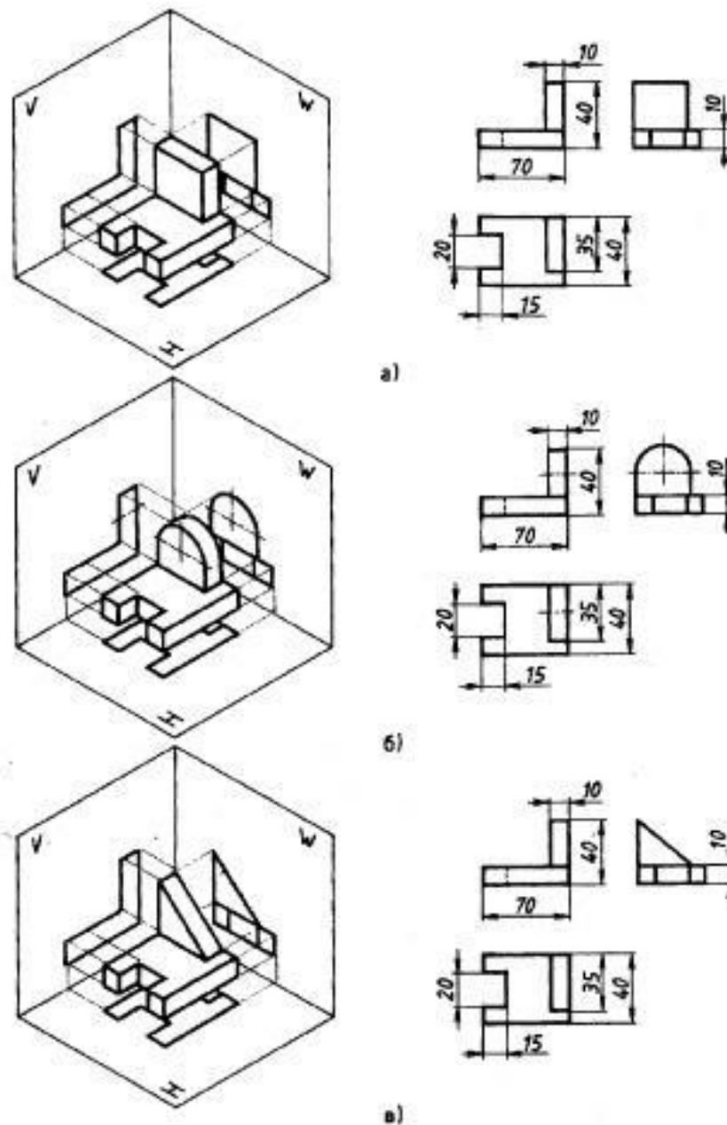
Рис. 128. Проецирование деталей на три плоскости проекций
