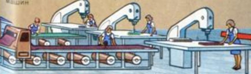
Окончательное вырезание деталей на ленточных раскройных машинах
