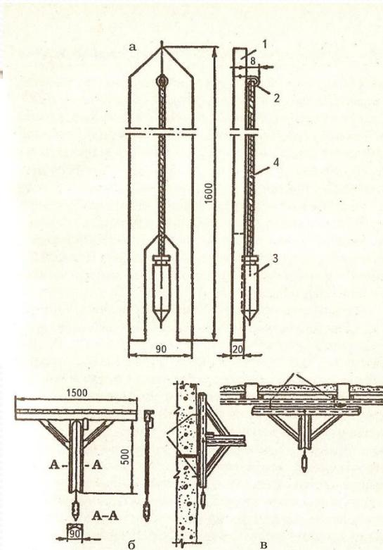
Рис. 44. Провешивание вертикальных и горизонтальных поверхностей:
