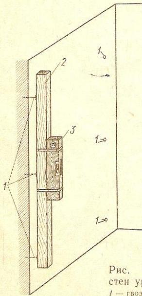
Рис. 37. Провешивание стен уровнем с правилом:
