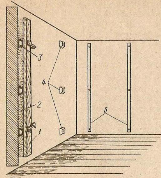
Рис. 39. Устройство растворных марок и маяков на стенах:
