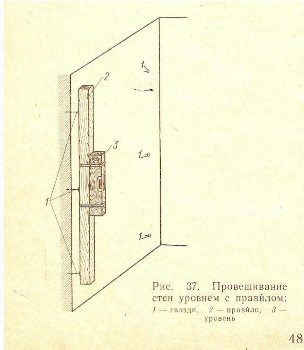
Рис. 37. Провешивание
