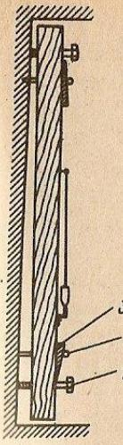
Рис. 41. Крепление специального правила для устройства растворных маяков:
