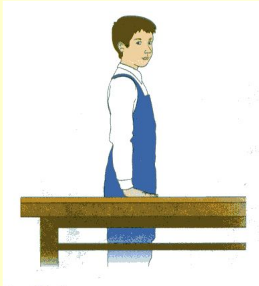
Рис. 16. Соответствие верстака росту работающего
