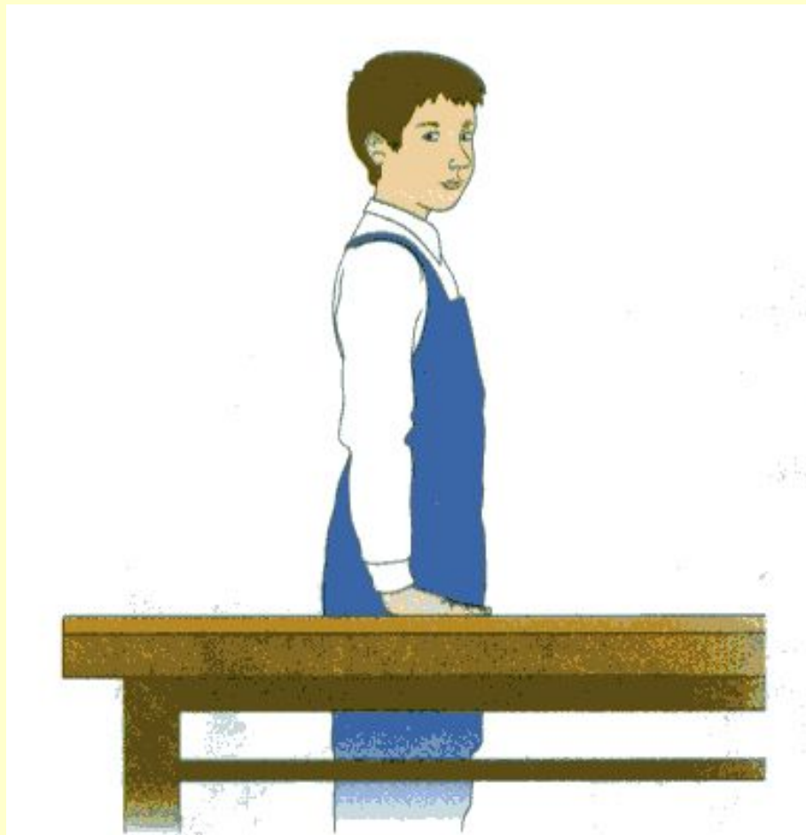
Рис. 16. Соответствие верстака росту работающего
