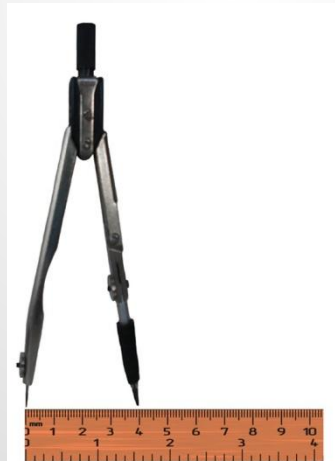
Отмеривание радиуса окружности по линейке
