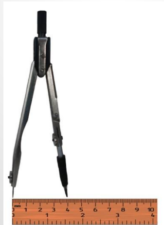
Отмеривание радиуса окружности по линейке
