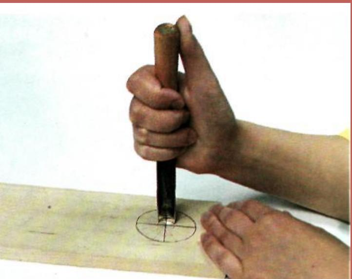
Вокруг сердцевины материал снимают отлогой стамеской шириной 12-18 мм
