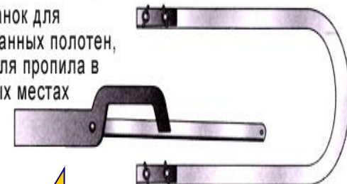
лобзик для работы с ножовочным полотном
