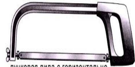
лучковая пила с горизонтально установленным полотном
