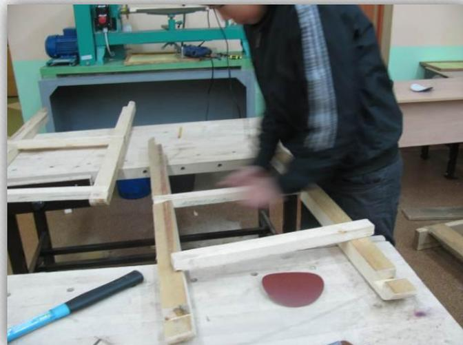
*10. Шлифовка заготовок.*
