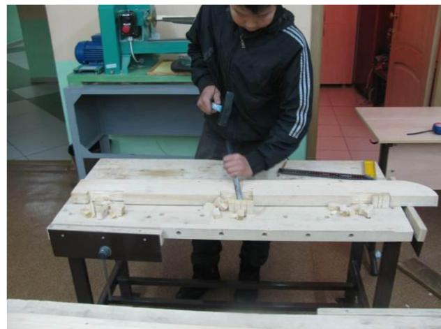
*5.Разметка, распил поперечин.*
